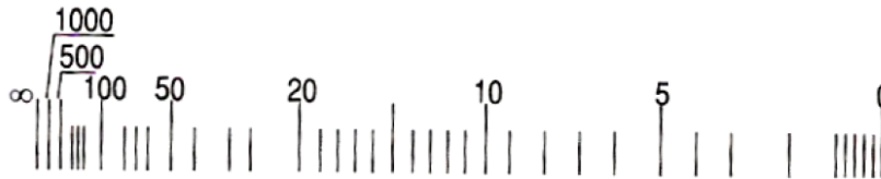
Rys.9. Podziałka omomierza szeregowego
